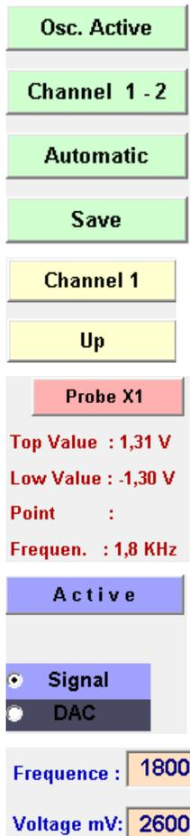
**Osciloscopio Activo/Pasivo:** Botón de Osciloscopio activa el osciloscopio o pausa la imagen actual y al hacer clic en el botón Guardar, guarda dicha imagen en la memoria.
